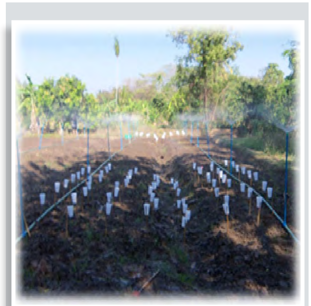
ภาพที่ 11 การประเมินประสิทธิภาพของระบบการให้น้ำแบบสปริงเกลอร์โดยวิธี Can test
